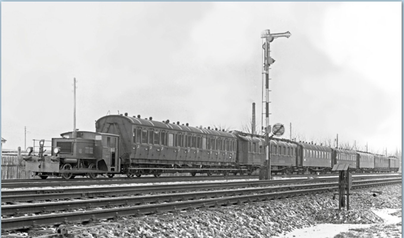
Die zweiachsige Kleinlokomotive 4050 der Münchner Lokomotivfabrik Kraus-Maffei zieht im Jahr 1932 eine bunte Mischung aus Schnellzug- und Abteilwagen, die bis auf eine Ausnahme alle bayerischen Ursprungs sind. Die Kleinlok wurde wegen fehlender Bewährung schon im Jahr 1937 wieder aus dem Bestand der Deutschen Reichsbahn gestrichen.
